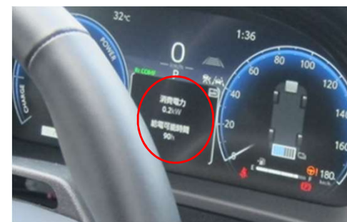
図6 給電を継続している際の運転席パネルでの消費電力と給電可能時間の表示(赤い○)
