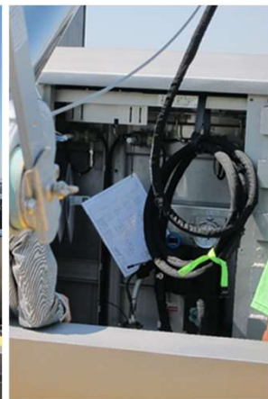
図17 釣り竿のようにバンカリング施設岸壁から“まほろば”に延ばされた水素供給ホース
