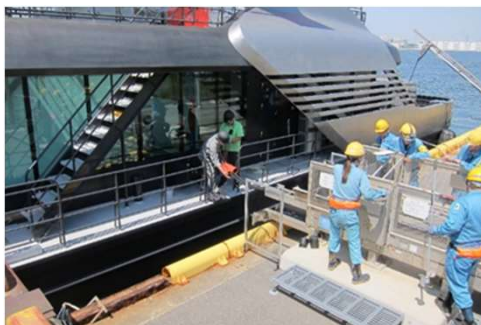
図18 “まほろば”に搭載された蓄電池を充電するためにバンカリング施設岸壁から延ばされた2本のケーブル
