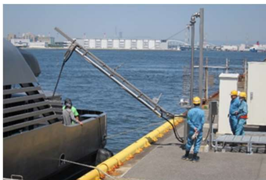
図17 釣り竿のようにバンカリング施設岸壁から“まほろば”に延ばされた水素供給ホース
