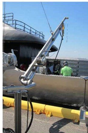
図17 釣り竿のようにバンカリング施設岸壁から“まほろば”に延ばされた水素供給ホース
