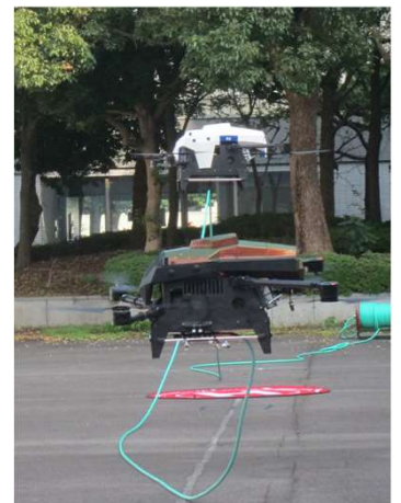
図5 1本のホースを持って協調飛行する2機の水素ドローン
