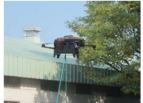
図4 ホースの中間を持って飛行する別の水素ドローン
