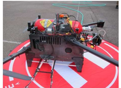
図2 カバーを外した水素ドローン（赤色のボンベが水素容器）
