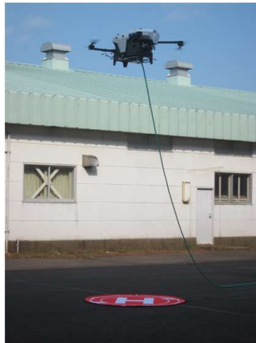
図3 ホースの端を持って飛行する1つの水素ドローン
