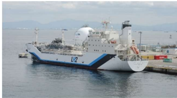
図2 川崎重工業建造の「液化水素運搬船 すいそふろんていあ」
