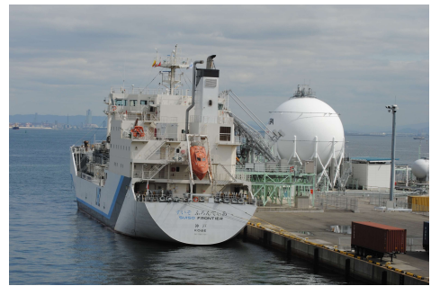
図2 川崎重工業建造の「液化水素運搬船 すいそふろんていあ」
