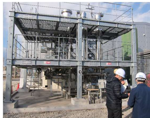
図19 H 2 とCO 2 を高温で反応させて、CH 4 を合成するメタネーション装置
