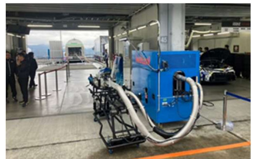
図4 液体水素充填ユニット
