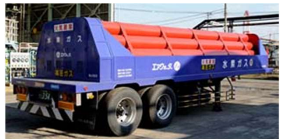
図3 水素輸送用トレーラー https://shinko-airtech.com/gasliquid_H2.html
