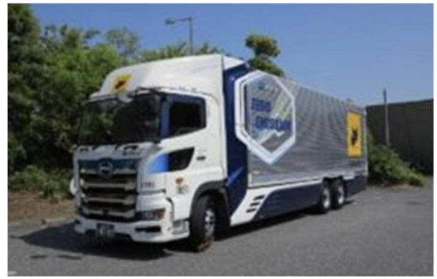
図8 「日野プロフィア」を改良したFC大型トラック
