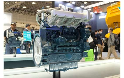
図10 クボタが開発を進める水素エンジンのプロトタイプ
