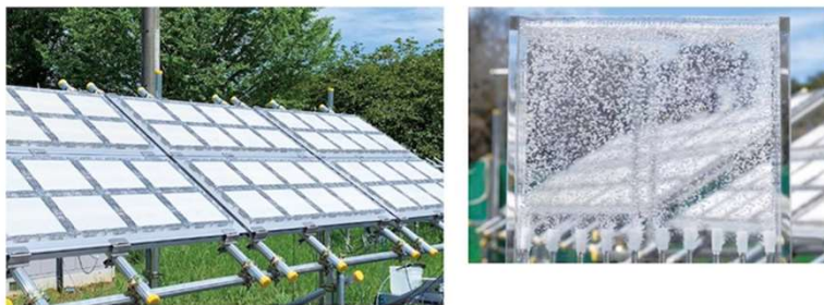
図3 光触媒パネル反応器の外観（左）と、光触媒パネル反応器から生成した水素と酸素の混合気体（右）
