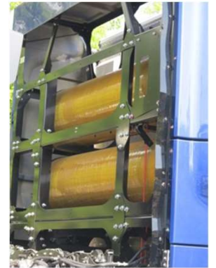
図9 キャビン裏に設置された水素タンク
