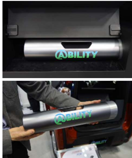
図6 水素カートリッジ（上：装着時、下：取り出し時）の様子
