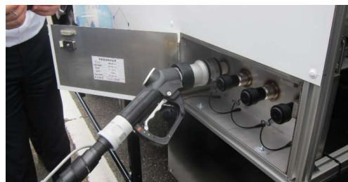
図4 水素エンジントラックの4系統の容器への水素充填作業
