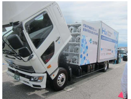
図2 水素燃料仕様に改造した市販の4トンアルミパネルバンディーゼルトラック
