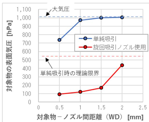
実機による減圧性能の計測結果
