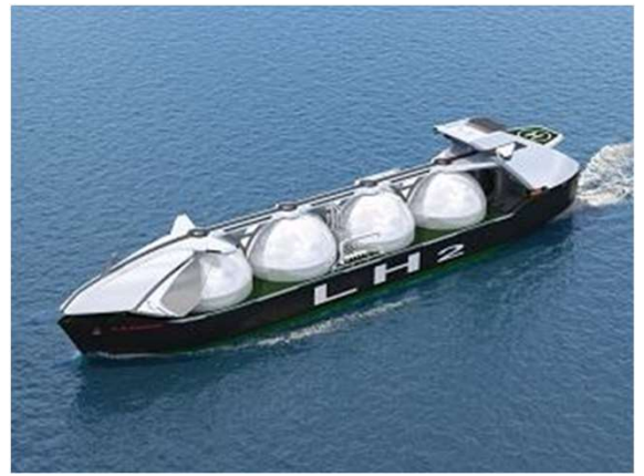
図2 160,000 m 3 型 液化水素運搬船完成イメージ ( https://www.khi.co.jp/pressrelease/detail/20220422_1.html )
